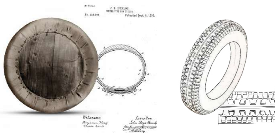
John Boyd Dunlop y su primera patente del neumático con cámara de aire (Dunlop). A la derecha, ejemplo de diseño de neumático registrado en España en 1926 (nº5211).
